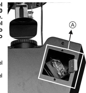
¡Atención! Compruebe la etiqueta en el lado posterior del dispositivo o lea las especificaciones técnicas en este manual para saber qué lámpara utilizar. ¡Nunca instale lámparas con un vatiaje superior! Las lámparas con un vatiaje superior generan temperaturas para las que el dispositivo no ha sido diseñado. Si utiliza un transformador de lámpara, se quemará debido a la sobrecarga de corriente.
