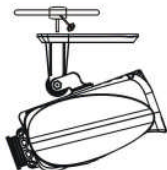
Montado em truss
