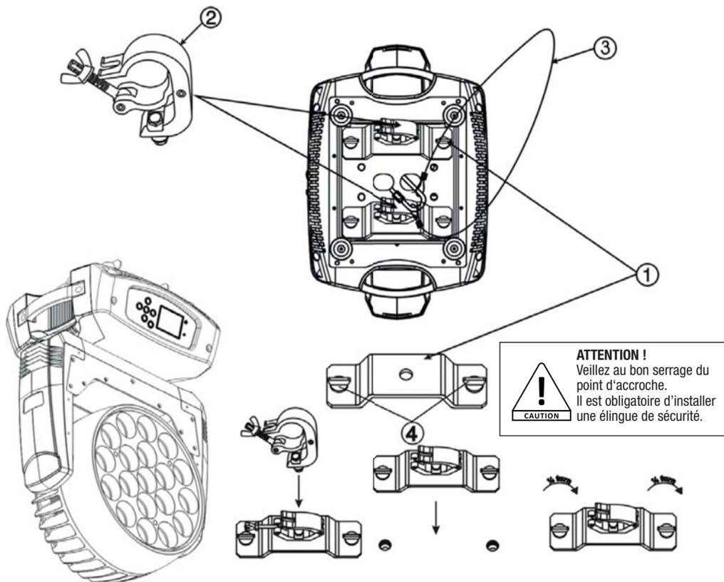
La lyre Oz-19x15QC est fournie avec deux systèmes QuickLock qui vous garantissent des manipulations rapides. L'exemple ci-contre vous montre le principe de montage des fixations Omega.
