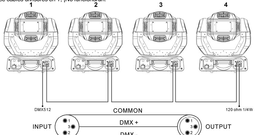
Cada efecto luminoso en la cadena necesita disponer de su propia dirección de inicio de forma que sepa qué comando del controlador debe decodificar.
