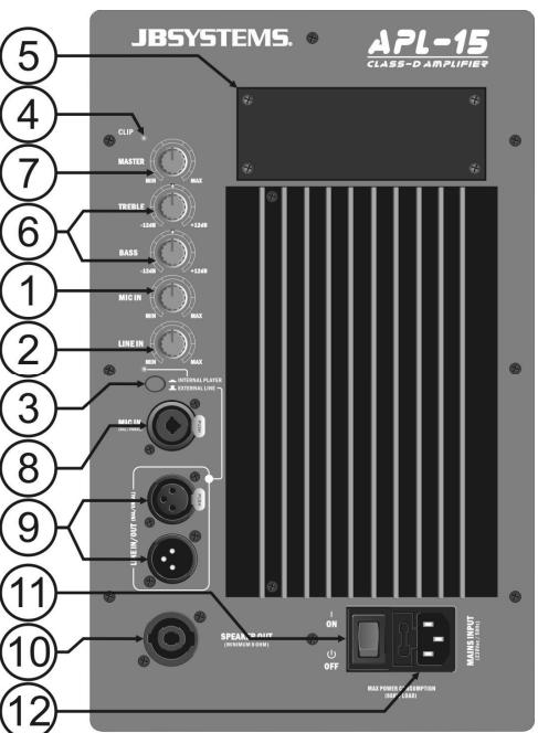
8. **ENTRADA DE MICRÓFONO:** Esta entrada acepta tanto micrófonos balanceados como desbalanceados. Puede utilizar el jack de  $\frac{1}{4}$ " y los conectores XLR de 3 clavijas machos.
