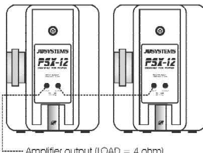
Parallel Anschluss @ 2Ω: (ACHTUNG: für die meisten Verstärker nicht geeignet!)
