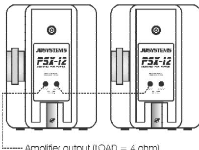
Connexion en parallèle sur 2Ω: (ATTENTION : ne convient pas à la plupart des amplificateurs!)
