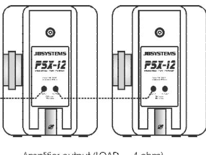
Conexão em paralelo a 2Ω: (ATENÇÃO: não indicado para todos os amplif.!!)
