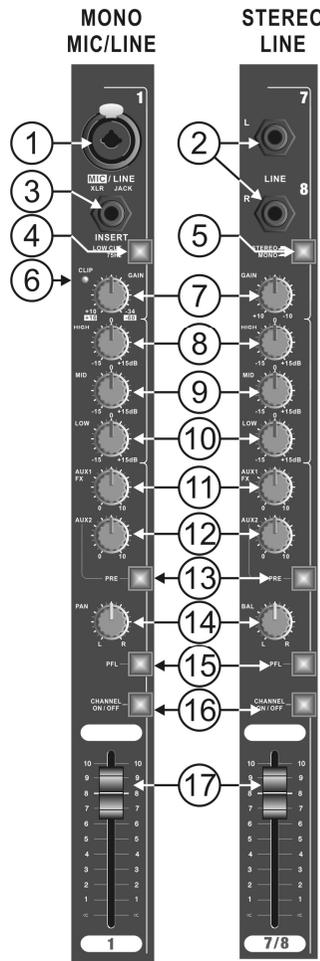
13. PRE-FADE / POST-FADE Schakelaar voor AUX SEND 2
