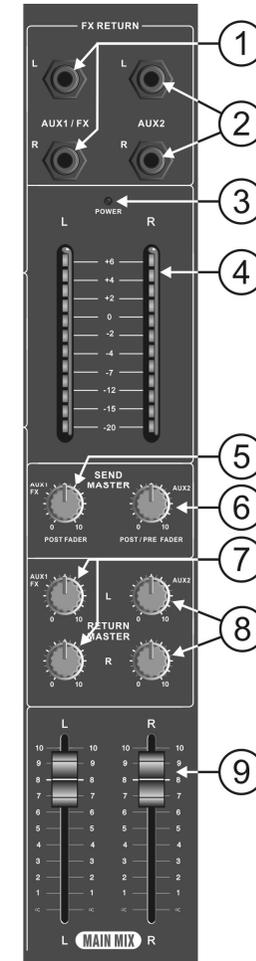
AUX2 FX Sends (12) van elk kanaal. Dit signaal wordt dan doorgestuurd naar de externe effectenprocessor (post-fade) of naar de podium monitors (pre-fade).
