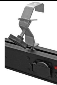
9. **ENDABDECKUNG:** Zur Installation der Schrauben/Muttern (zur Montage des Projektors) und des Stativadapters muss diese Endabdeckung auf einer Seite des Geräts abgenommen werden: lösen Sie die 4 Schrauben → nehmen Sie die Endabdeckung ab → setzen Sie die Schrauben/Muttern und/oder Stativadapter in die Schiene ein → setzen Sie die Endabdeckung zurück → schrauben Sie die 4 Schrauben wieder an → fertig!
