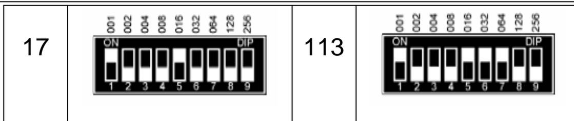
Der Laser hat 10 Betriebskanäle (internationaler Standard DMX 512 Signal). Es ist darauf zu achten, dass entsprechend 10 Kanäle hinter der Startadresse nicht für andere DMX-Geräte belegt werden dürfen. Die nächste mögliche Adresse eines DMX-Gerätes, welcher hinter ein Gerät mit Startadresse 1 geschaltet ist, muss somit mindestens 11 sein.
