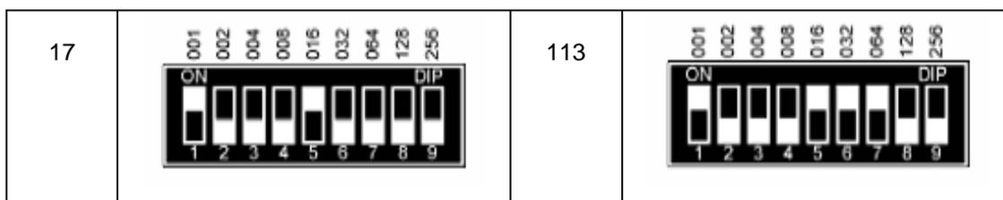
Der Laser hat 8 Betriebskanäle (internationaler Standard DMX 512 Signal). Es ist darauf zu achten, dass entsprechend 8 Kanäle hinter der Startadresse nicht für andere DMX-Geräte belegt werden dürfen. Die nächste mögliche Adresse eines DMX-Gerätes, welches hinter ein Gerät mit Startadresse 1 geschaltet ist, muss somit mindestens 9 sein.
